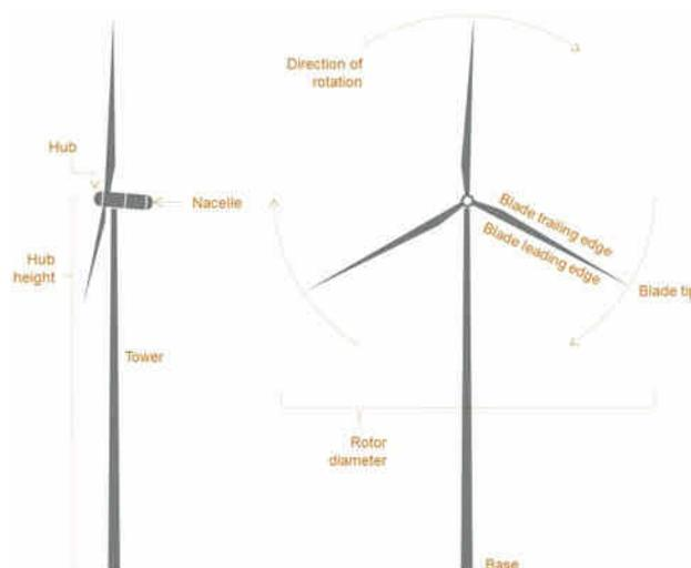
Abb. 1: Schemazeichnung einer heutigen Windenergieanlage
